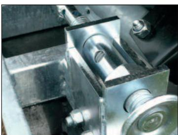
Vérin de pied boulonné sur ossature
