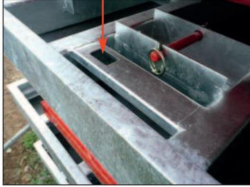
Fixation de console par tige tête marteau 90KN
