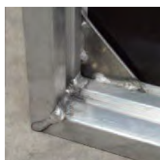
Renforts des angles par goussets 80x80 ép. 5mm
